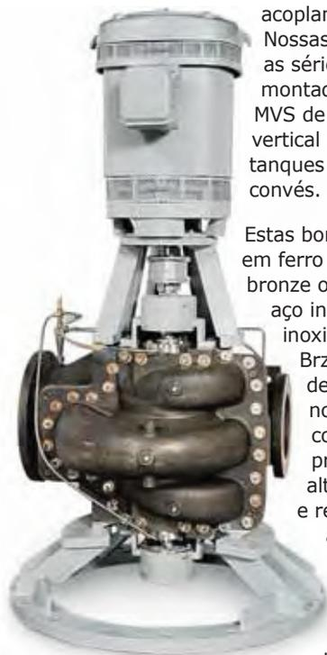
Estas bombas estão disponíveis em ferro maleável (todo ferro, bronze ou adaptado com aço inoxidável 316), aço inoxidável 316, Ni-Al-Brz e titânio. Também desenvolvemos um novo material composto proprietário de alta resistência e resistente à corrosão para as partes internas de nossas bombas.
