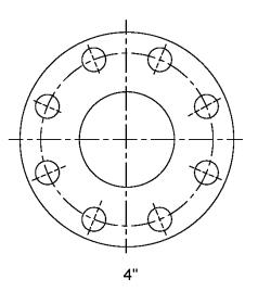
Figure 19. Model 855 Universal Discharge Flange
